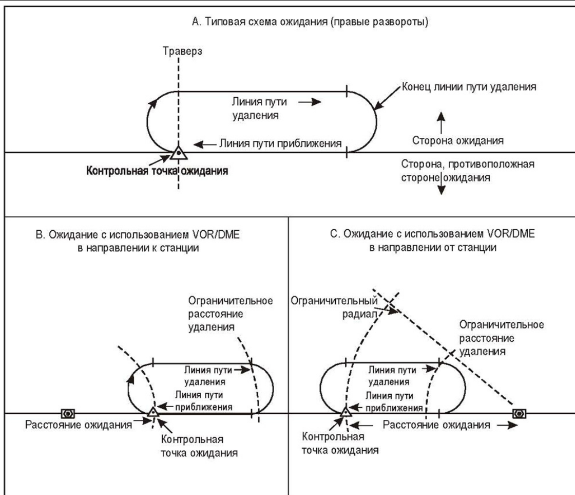
Рис. I-6-1-1. Конфигурация типовой схемы ожидания с правым разворотом и соответствующая терминология
